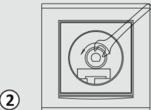
Подсоединить провода зажимов с задней стороны механизма, вставив зачищенные концы в пазы контактных зажимов, с лицевой стороны механизма затянуть винты до упора.
