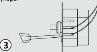
Установить механизм изделия в углубление в стене (подрозетник), зафиксировав его стопорными винтами, затянув их до упора.
